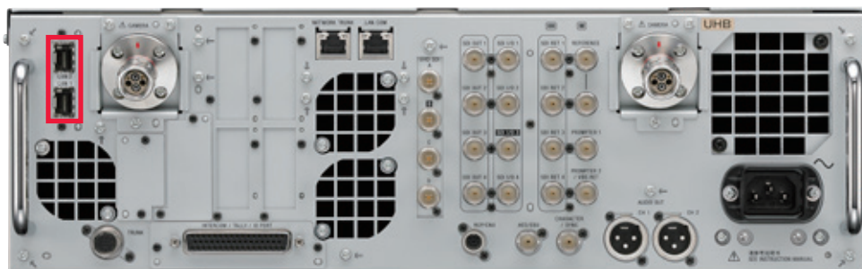
HDCU-5000后视图，安装了选购的HKCU-SFP50
