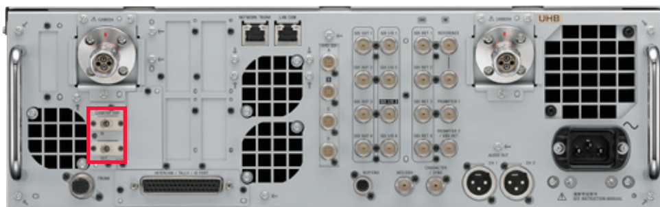
HDCU-5000 后视图，安装了选购的HKCU-SM50
