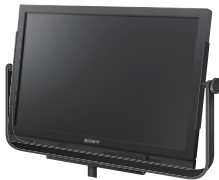
采用轭式安装的LMD-A240 (需使用第三方轭式支架)
